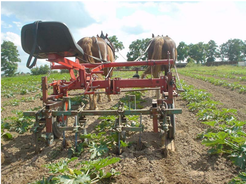
Abbildung 22: Hacken in einreihigen Kulturen (Zucchini) mit der „Amerikanischen Hacke“
