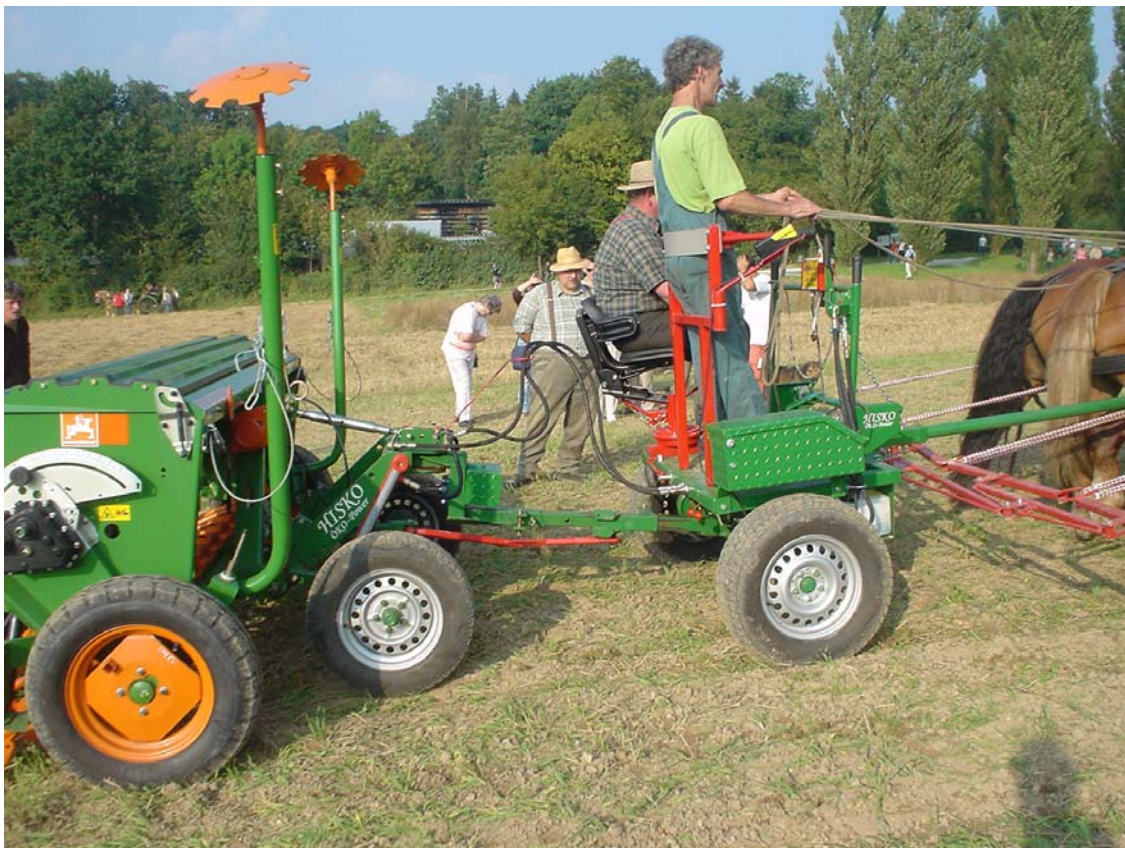
Abbildung 24: Hisko-Vorderwagen mit Dreipunktanhängung und angehängter Drillmaschine
